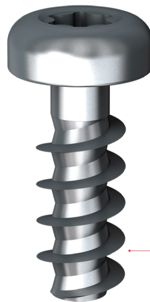
Die Polymate30 Schraube mit 30° Flankenwinkel und Kernausschleifung
